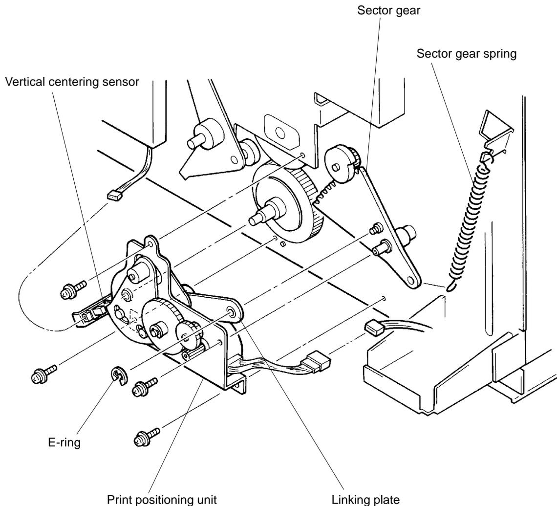
**5. Print Positioning Pulse Motor**
