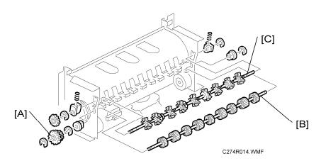
■ Master eject unit (► Master Eject Unit)
